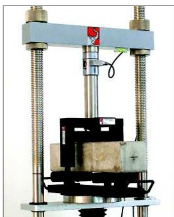
10. Испытания бетонных балок на изгиб
