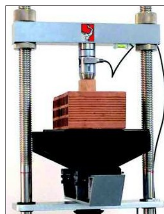
12. Испытание кирпичных блоков на прочность
