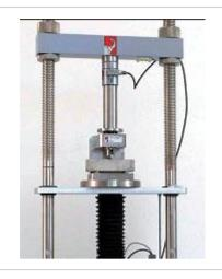
Испытания цемента на изгиб
