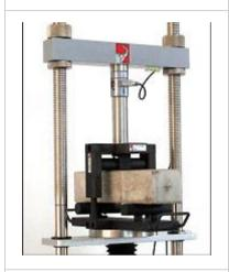
Испытание бетонных балочек на изгиб
