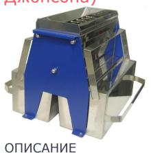
Данные приборы предназначены для разделения пробы сыпучих материалов на две равные части.
