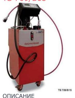
Используется для выполнения испытаний в Hoek камерах трехосного сжатия.
